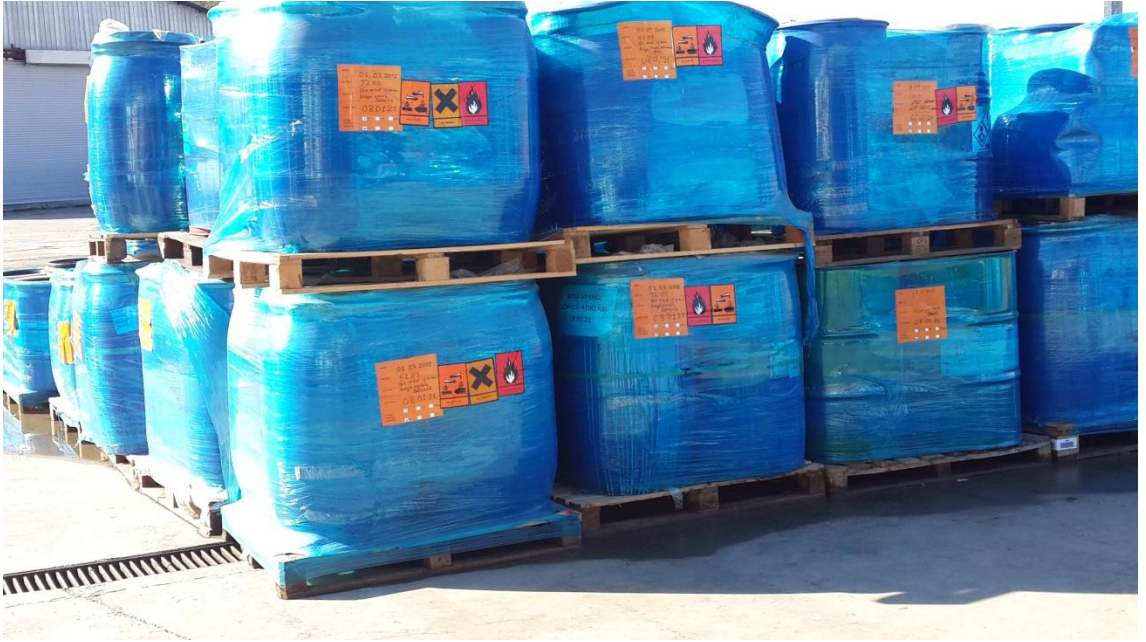
Resim 4.7. Üçüncü tesiste ara depolama veya nakliye öncesi ambalajlama ve etiketleme yapılan fiçı atıkların görünümü
