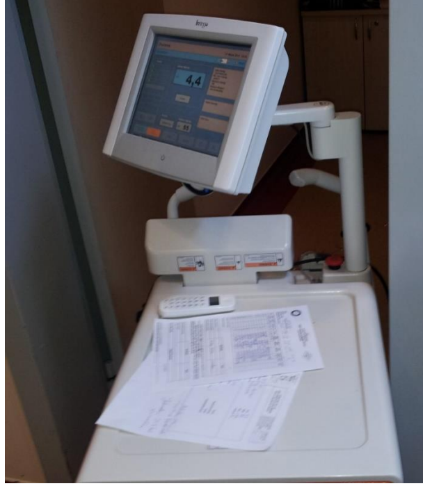
Şekil 4.33. Otomatik radyofarmasötik enjeksiyon cihazı
