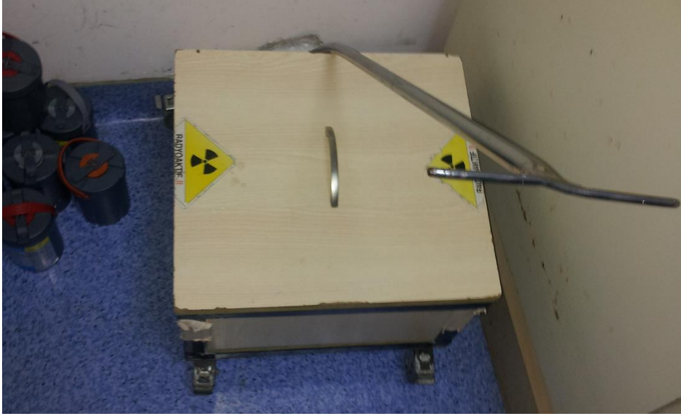
Şekil 4.48 Radyofarmasötiklerin başka bölümlere transferinde kullanılan taşıma kabı
