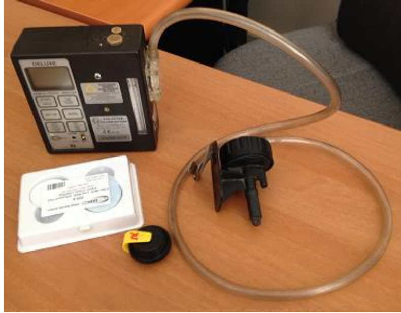
Şekil 9. Kişisel Örnekleme Pompası, Siklon Başlık, MCE Membran Filtre ve Numune Kaseti
