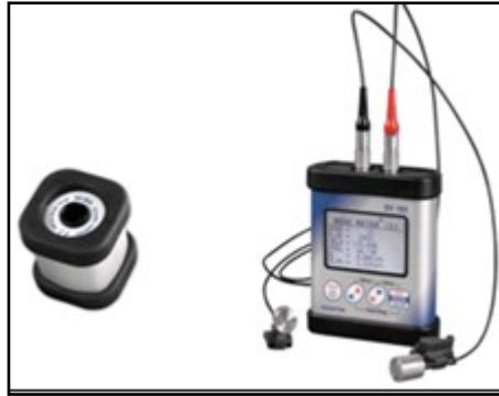
Resim 3.1. 30A Kalibratör ve SV102 Gürültü Dozimetresi
