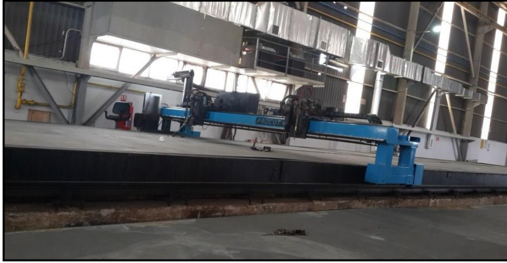
Resim 2.1. CNC Tezgâhında Sacların Kesilmesi
