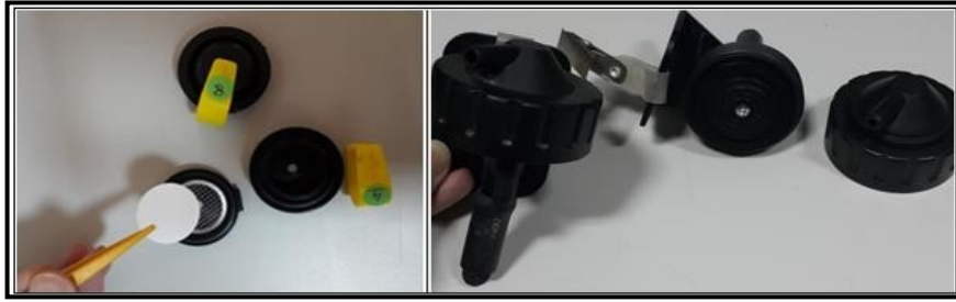
Resim 3. 3. Solunabilir Toz Örnekleme için Kullanılan Toz Filtresi, Filtre Kaseti ve Siklon Örnekleme Başlığı
