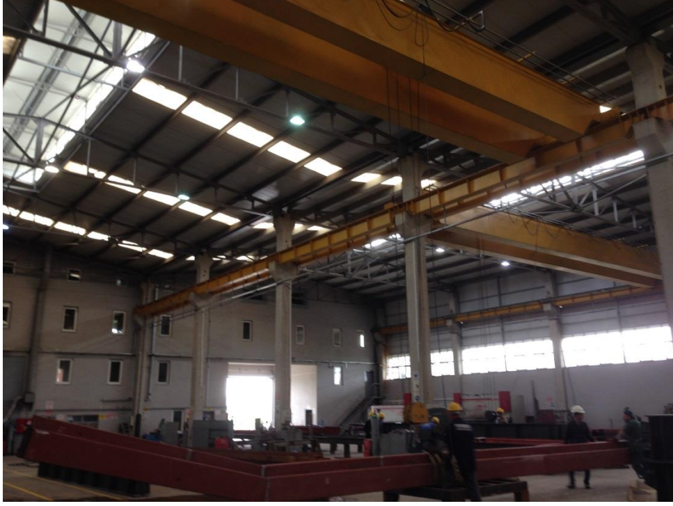
Şekil 2.15. Gezer vinç ile malzemelerin taşınması
