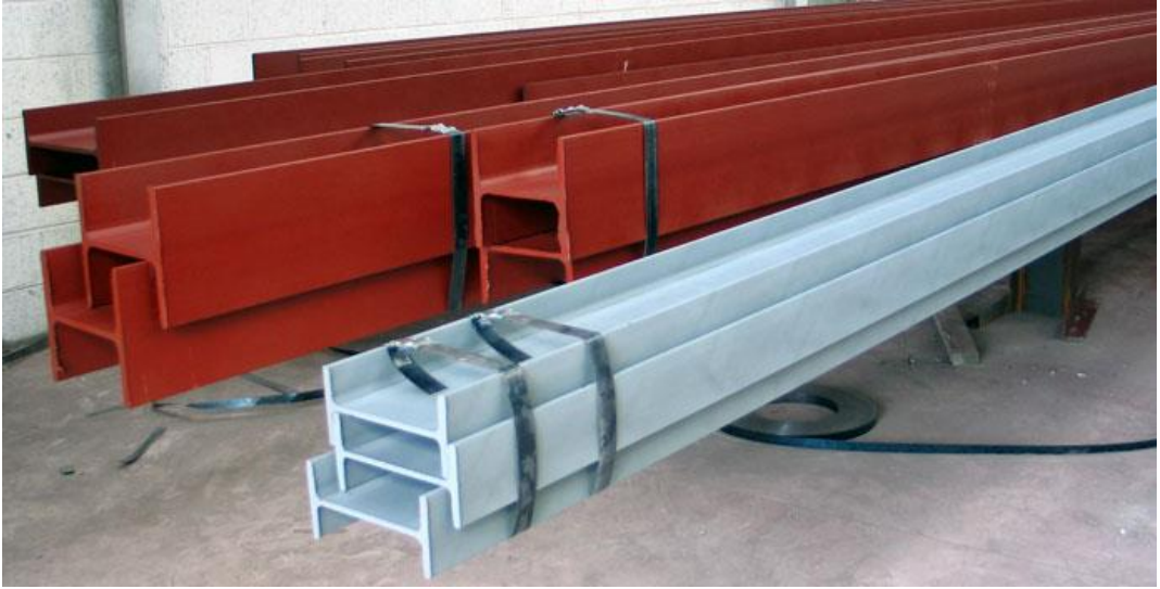
Şekil 2.13. Ön astar çekilmiş çelik profil malzemeler
