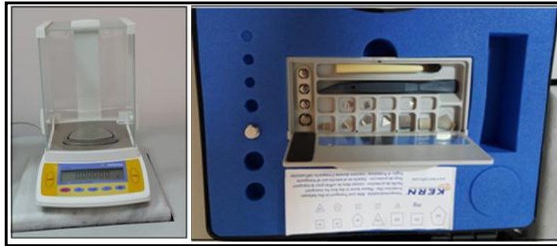
Resim 3.3. Toz numunelerinin gravimetrik analizi i in kullanılan beŐ dijital hassas terazi ve hassas terazinin dođrulanmasında kullanılan etalon k tle seti
