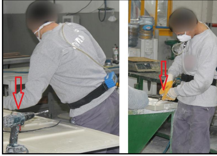
Resim 4.25. Breyzle çalışan montaj operatörü ve havalı matkapla çalışan pres operatörü
