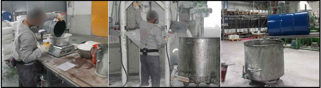
Resim 4.2. Katkı malzemelerinin tartılması / hamur kazanına kalsit ve polyester aktarılması
