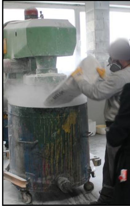
Resim 4.36. Mikserle katkı malzemesi boşaltan çalışanın ergonomik olmayan durumu
