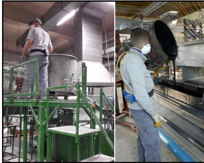
Resim 4.8. SMC makinesinin beslenmesi sırasında oluşan yoğun stiren maruziyeti sırasında çalışanların toz maskesi takması
