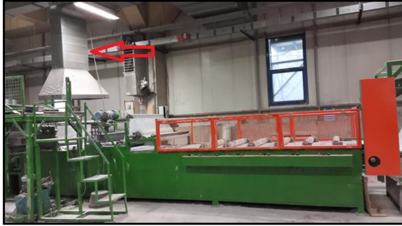
Resim 4.6. Hamur boşaltımının yapıldığı noktada lokal emiş yapılan bir SMC makinesi
