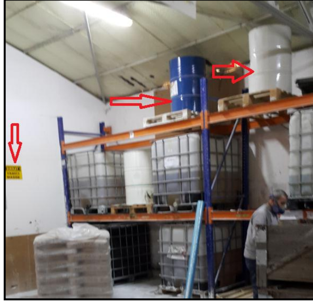
Resim 4.19. Kimyasalların düşmeye karşı korunmasız bir şekilde yüksekte istiflenmesi ve yanıcı madde uyarı levhası
