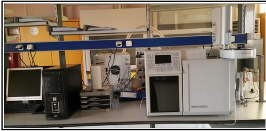
Resim 3.8. Stiren analizinde kullanılan gaz kromatografi cihazı
