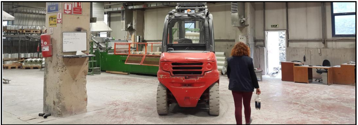
Resim 4.32. Yürüyüş yollarının ayrılmadığı işletmede forkliftin çalışması
