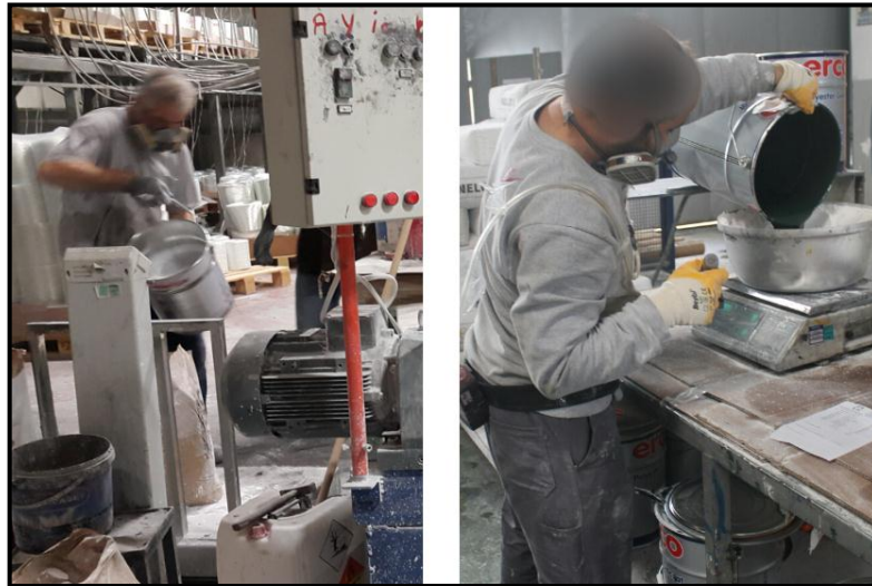
Resim 4.35. Katkı malzemelerinin tartımı sırasında çalışanların ergonomik olmayan durumları
