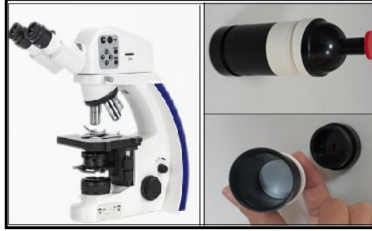
Resim 3.4. Lifsi toz sayımının yapıldığı faz kontrast mikroskobu ve lifsi toz örneklemesinde kullanılan membran filtre kasetleri
