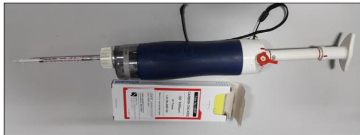
Resim 3.5. Anlık gaz ölçümünde kullanılan dedektör tüp pompası ve dedektör tüpü
