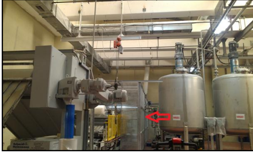
Resim 4.7. Etrafı kapatılmış ve otomasyonla beslenen SMC makinesi
