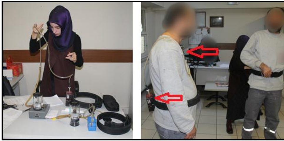
Resim 3.7. Ölçüm öncesi üretim alanı dışında temiz bir ortamda pompaların kalibrasyonlarının yapılması ve çalışanlara takılması
