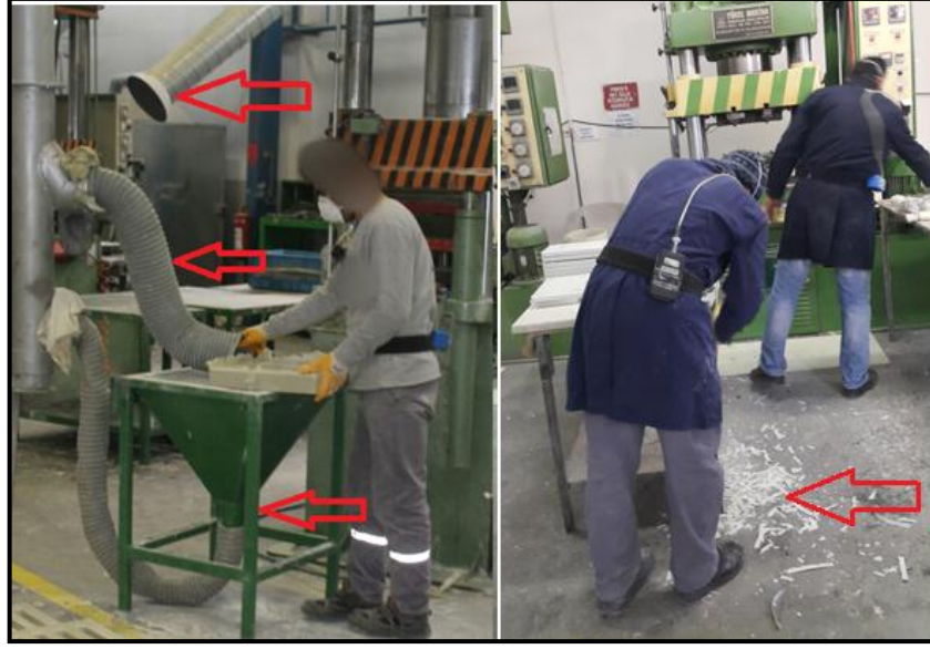
Resim 4.13. Lokal havalandırmanın yapıldığı bir ortamda toz emişi yapılan masada çalışma ve herhangi bir havalandırma olmadan yapılan çalışma
