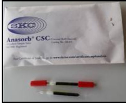
Resim 3.1. Stiren örneklenmesinde kullanılan aktif karbon içerikli sorbent tüpler
