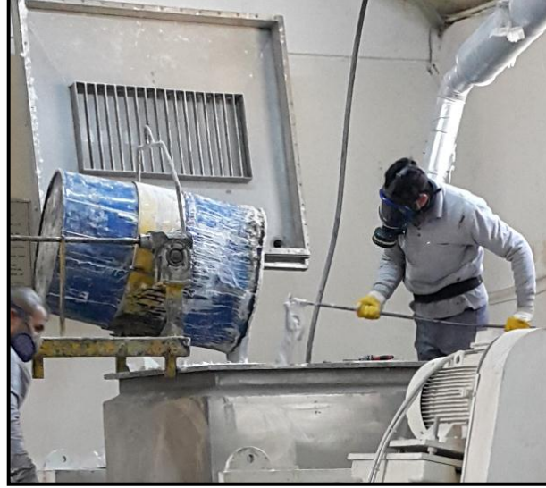
Resim 4.34. BMC makinesinde hamur boşaltımı yapan çalışanın ergonomik olmayan durumu
