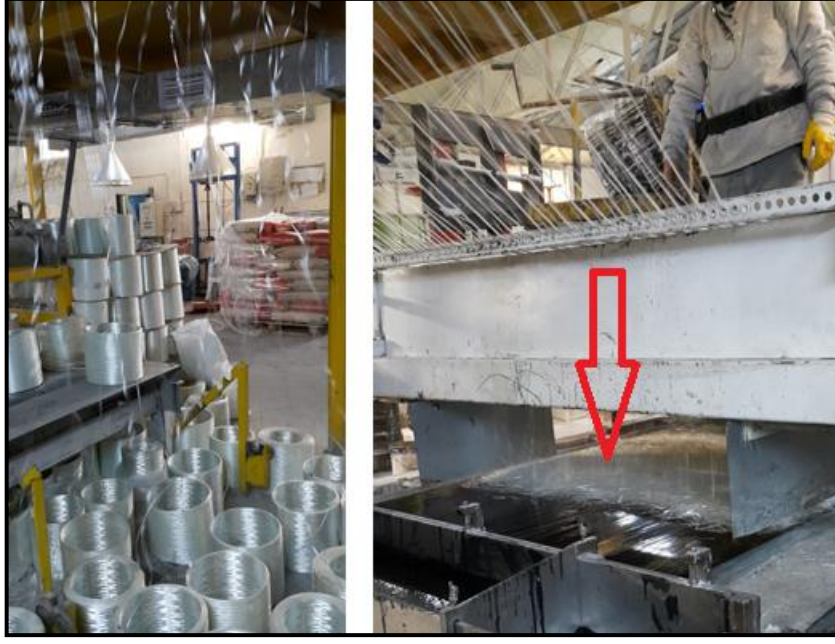
Resim 4.4. Cam elyaf bobinlerinden SMC makinesine elyaf sarımı ve SMC makinesinde cam elyafının kesilmesi sırasında oluşan cam elyaf tozu maruziyeti
