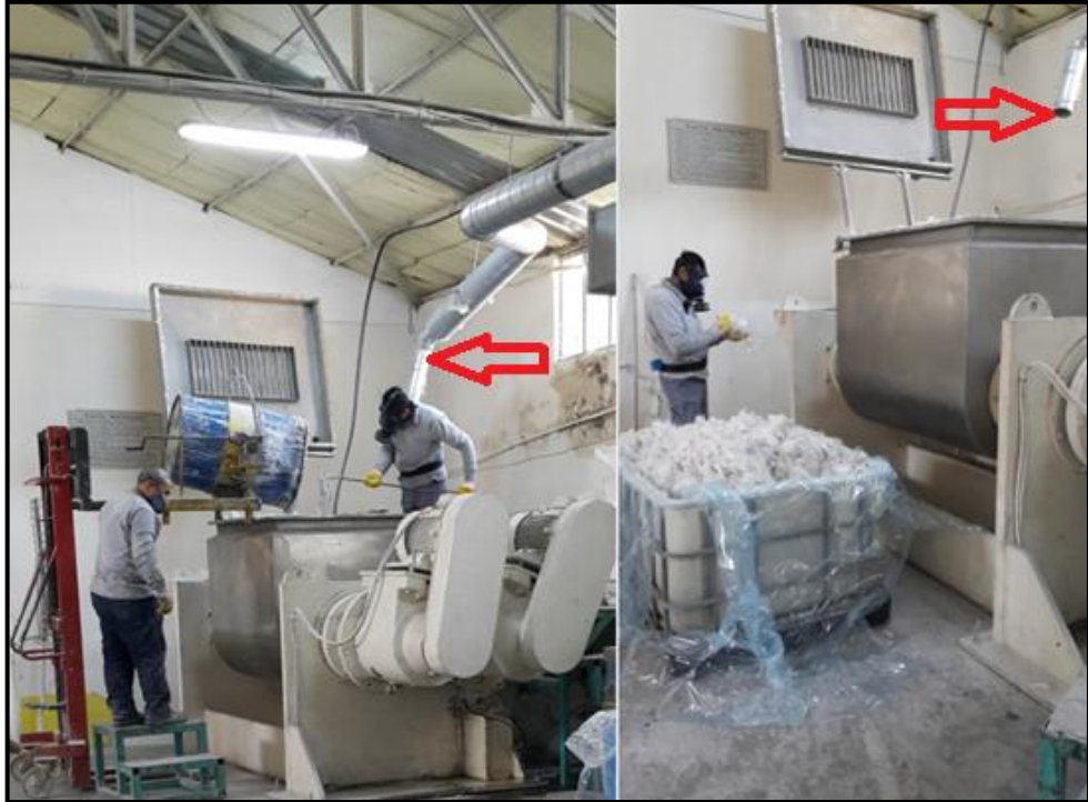
Resim 4.9. Yetersiz lokal havalandırmayla çalışılan BMC makinesine hamur boşaltımı ve kırpık elyaf yüklenmesi
