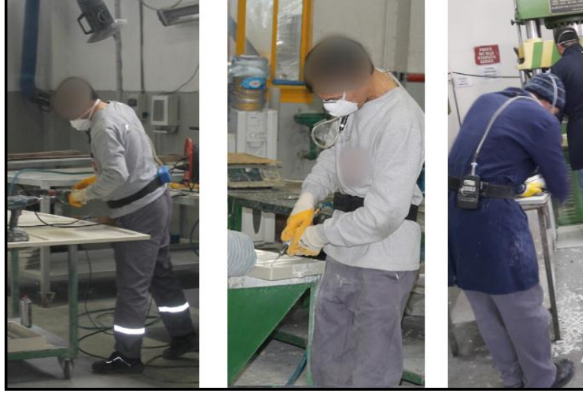
Resim 4.38. Alçak çalışma masasında çalışmadan kaynaklanan hatalı duruş pozisyonları
