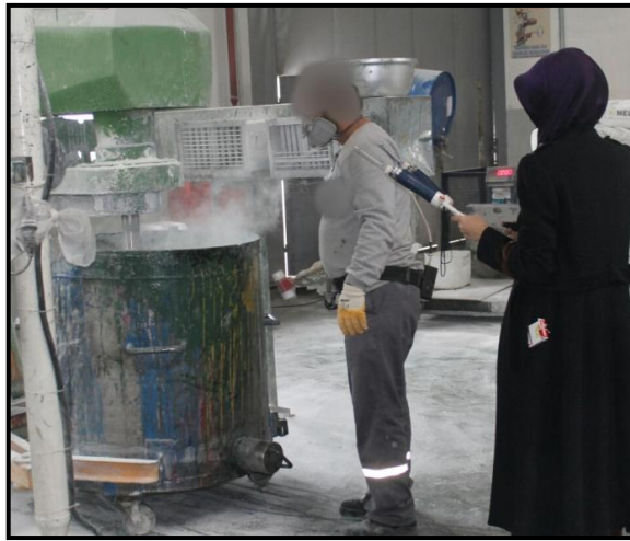
Resim 4.1. Mikserde malzeme karışımı sırasında yapılan anlık gaz ölçümü
