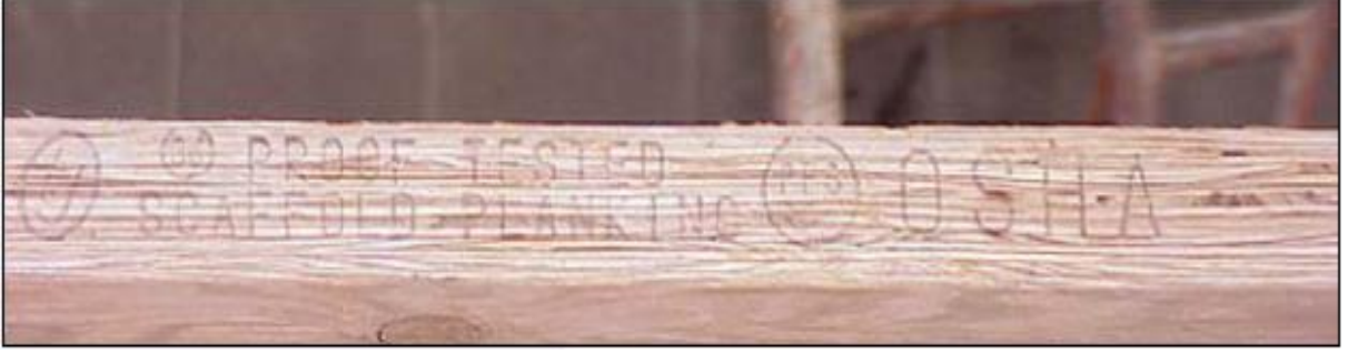
Şekil 77. İskele platformu tanımlanmış olmalıdır [24].
