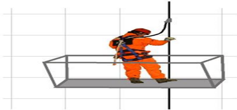
Şekil 24. Dikey Yaşam Hattı Ve Güvenlik Elemanları
