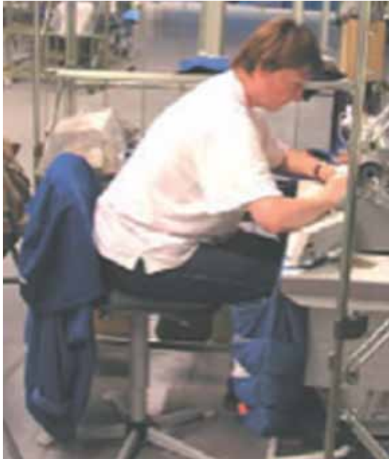
Resim 1. Eski iş istasyonu (çalışan sürekli masaya eğilir halde, masa çok alçak ve bacaklar rahatsız pozisyonda)
