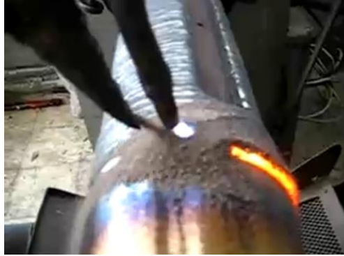
Şekil 3. Toz Altı Ark Kaynağı Metodu
