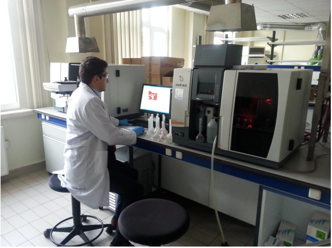
Resim 3.2. Alevli atomik absorpsiyon spektrofotometresi cihazı ve numune analizi
