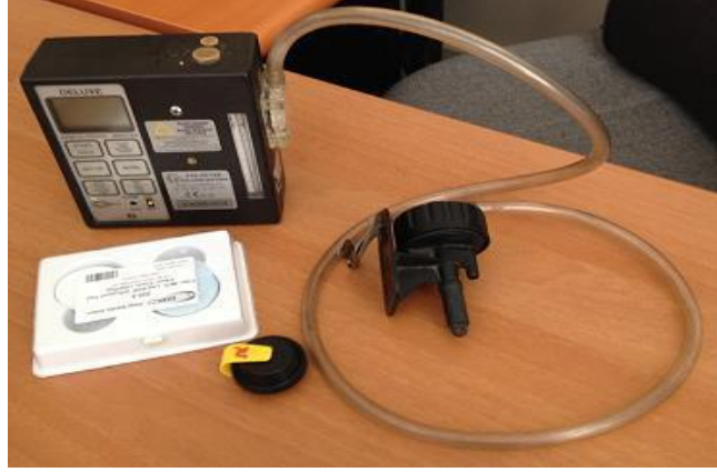
Resim 3.1. Kişisel örnekleme pompası, siklon başlık, membran filtre ve numune kaseti
