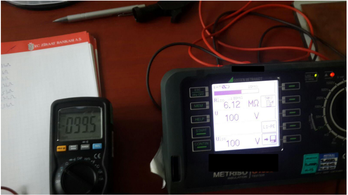
Resim 3.2. Cihazın ve multimetrenin gerilim göstergelerinin karşılaştırılması
