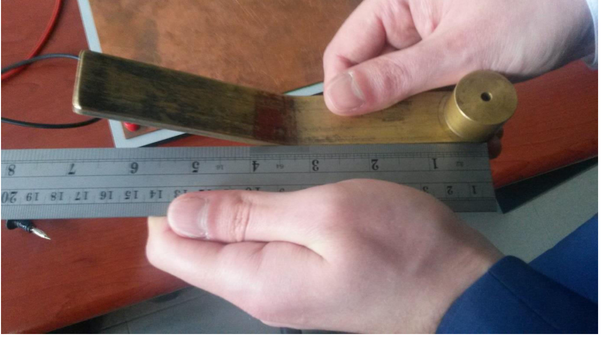
Resim 3.5.İç elektrotun kalite kontrol ölçümü
