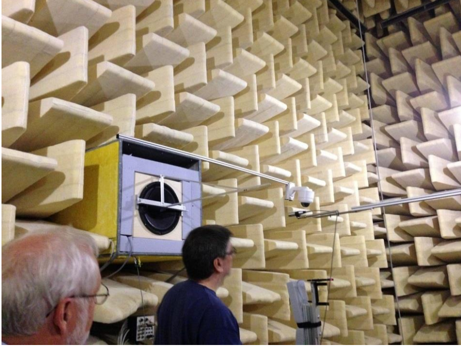
Şekil 10. Sessiz Oda ve Kalibrasyon Düzenneđi Örneđi[19]
