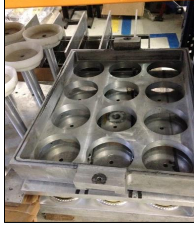
Resim 4.16. Termoform makinelerinde kullanılan kalıplardan biri
