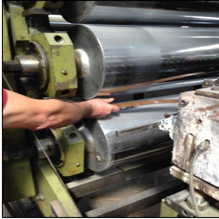
Resim 4.15. Levha ekstruder besleme silindirleri ve iş kazası örneği
