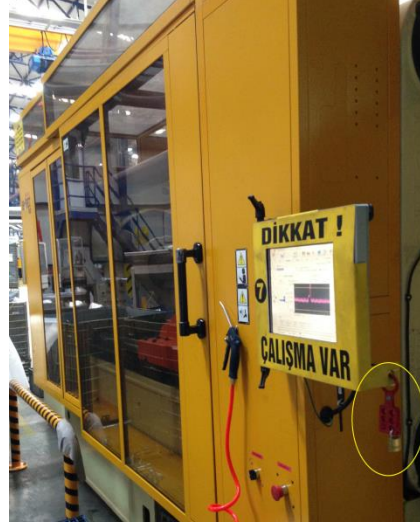
Resim 2.1. A işletmesi Bakım Sırasında etiketleme/kilitleme sistemi
