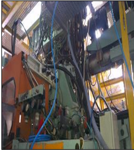
Resim 4.1. Şişirme makinesi - düzensiz makine tesisatı
