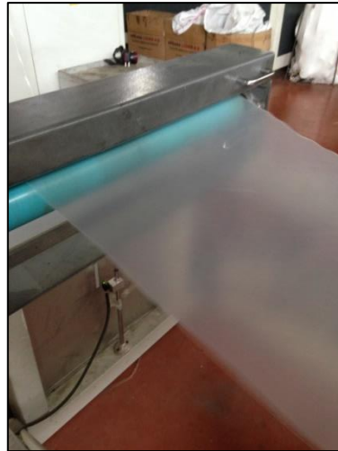
Resim 4.27. Termoform Rulo Levha Besleme Kısımı
