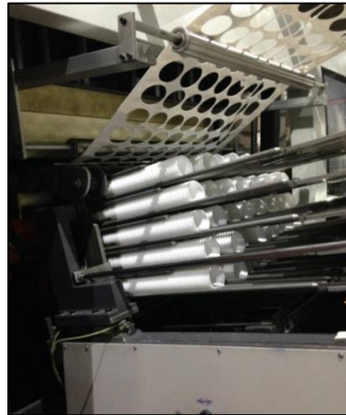
Resim 4.19. Termoform makinesi dizici kısmı
