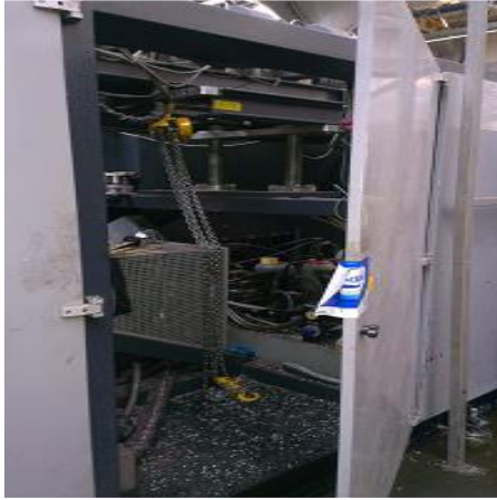
Resim 4.4. Makinelerin bakımı sırasında herhangi bir güvenlik önlemi alınmaması
