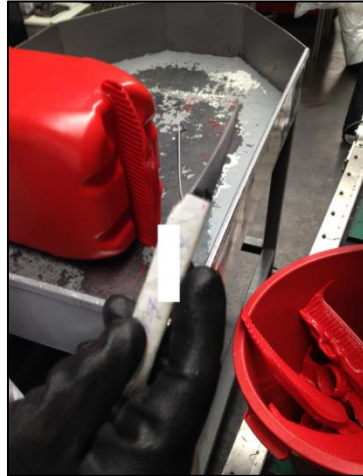
Resim 4.46. Bıçak kullanımı ve uygun olmayan eldiven kullanımı
