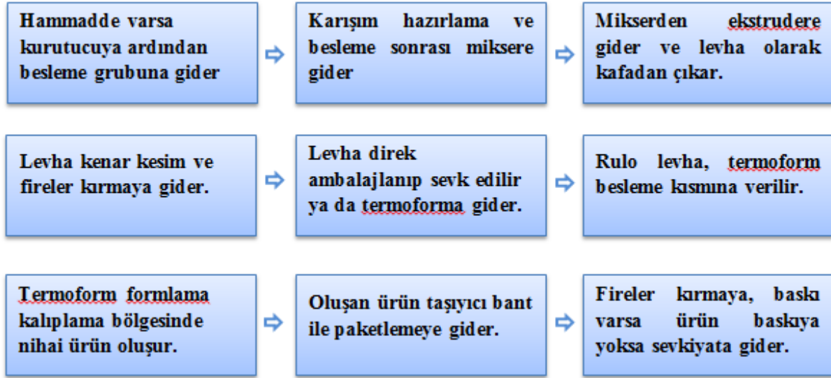
Şekil 3.4. G-H-I işletmeleri üretim akışı
