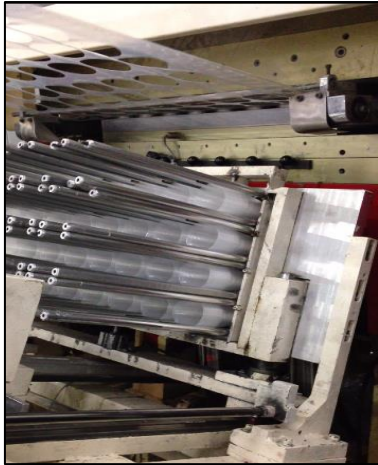
Resim 4.19. Termoform makinesi dizici kısmı
