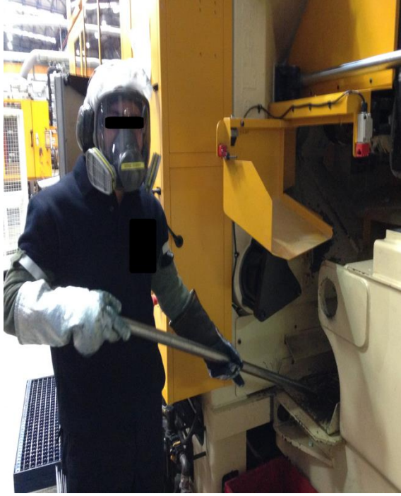
Resim 7. Pöç oluşumu temizlenirken çalışanın uygun KKDleri kullanması
