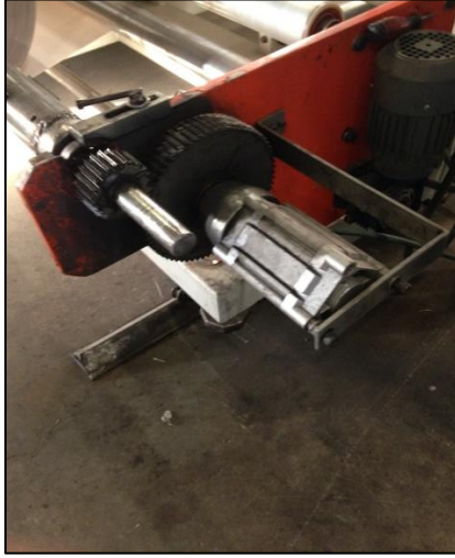
Resim 4.32. Bobin milinin muhafazasının açık olması nedeniyle veya bobin miline el sıkıştırma nedeniyle el sıkışması riski
