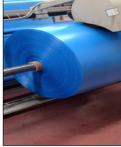
Resim 4.32. Bobin milinin muhafazasının açık olması nedeniyle veya bobin miline el sıkıştırma nedeniyle el sıkışması riski
