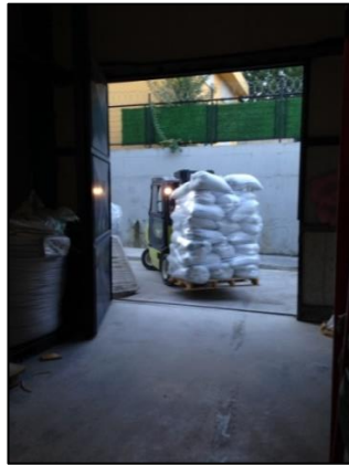
Resim 4.43. Forklift Operatörünün Görüş Alanının Kapanması ve Arızalı Forklift Kullanımı
