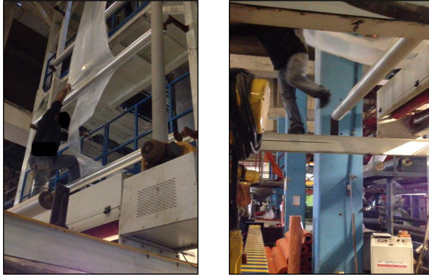
Resim 4.31. Yüksekte güvenlik önlemi olmadan çalışma
