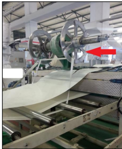
Resim 4.17. Levhada kenar fitesi oluşumu, levhanın kesildiği kısımlardan biri
