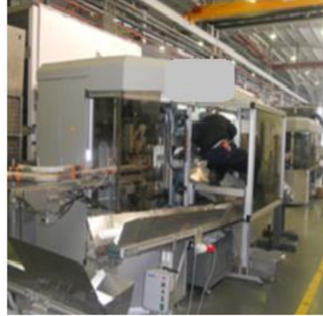
Resim 4.4. Makinelerin bakımı sırasında herhangi bir güvenlik önlemi alınmaması
