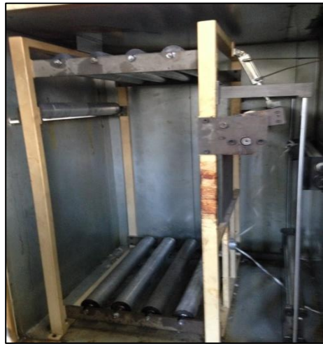
Resim 4.23. Termoform makinesi ısıtma borusu
