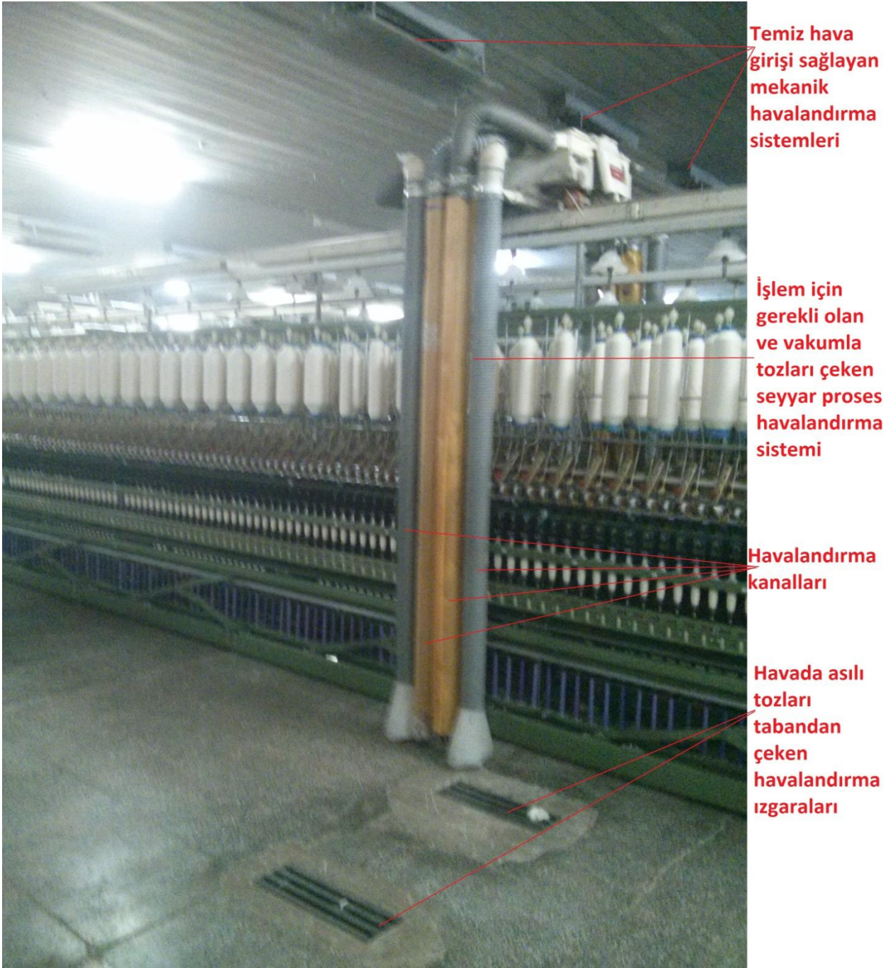
Şekil 15. Fitil makinesi ve havalandırma sistemleri
