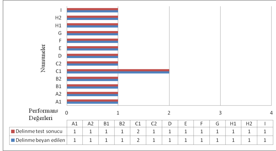
Grafik 4.22. Nitril kaplama eldivenlerin delinme direnci test sonuçları ile beyan edilen performans değerlerinin karşılaştırması
