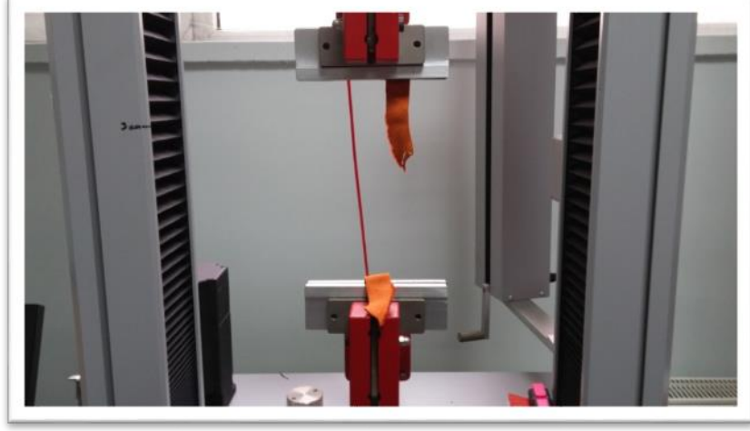
Resim 3.9. Düzgün bir şekilde yırtılmış deney numunesi
