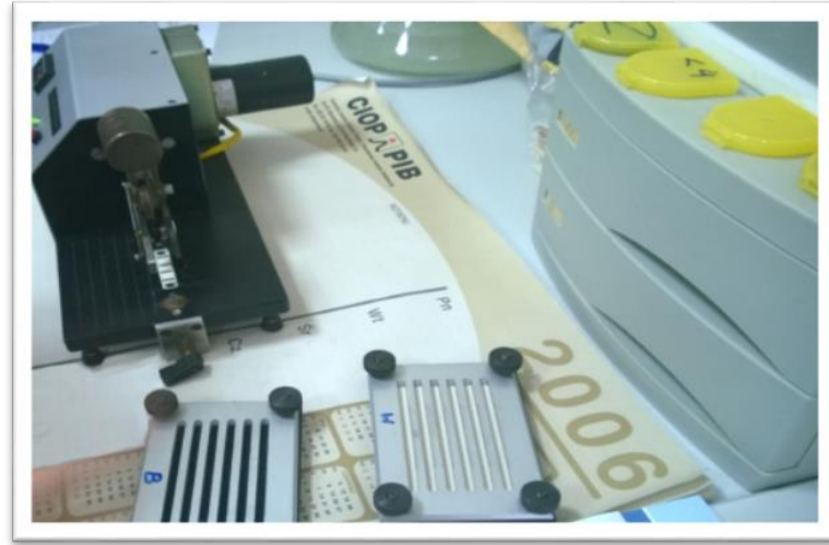
Resim 3.5. Bıçakla kesilme cihazı
