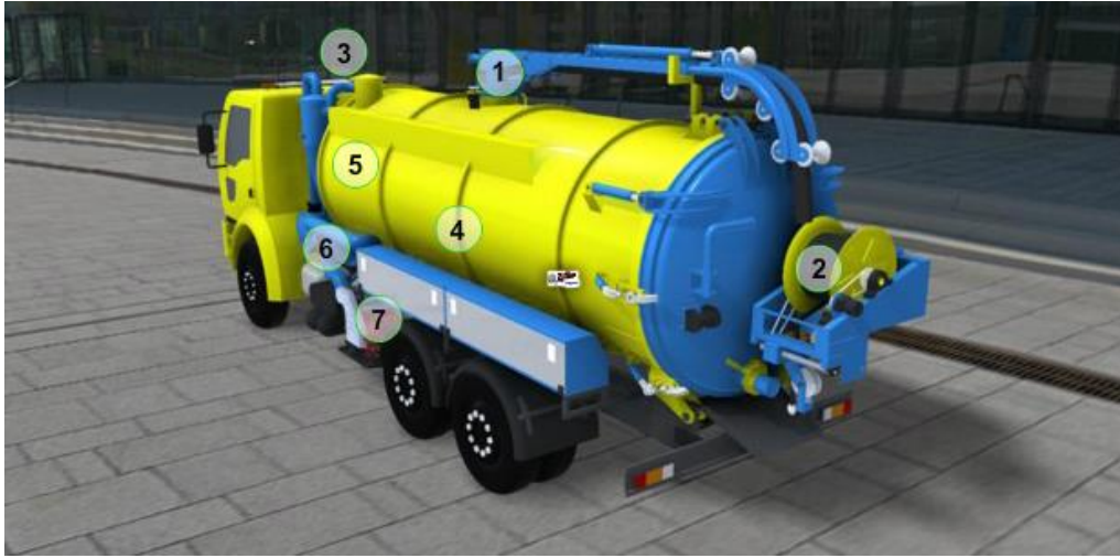
Şekil 2.5. Kombine kanal açma aracı
