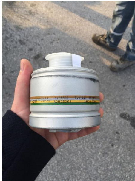
Resim 4 25. Muayene bacası kapalı ortam çalışmaları için yanlış gaz filtresi kullanımı
