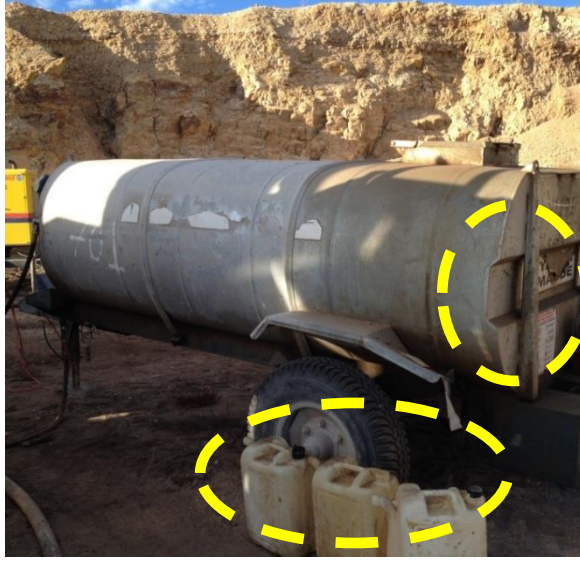
Resim 4.4. Yakıt tankı yanında bulunan yabancı maddeler
