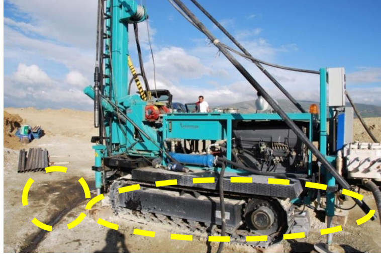
Resim 4.10. Sızıntıya karşı önlem alınmayan sondaj makinesi
