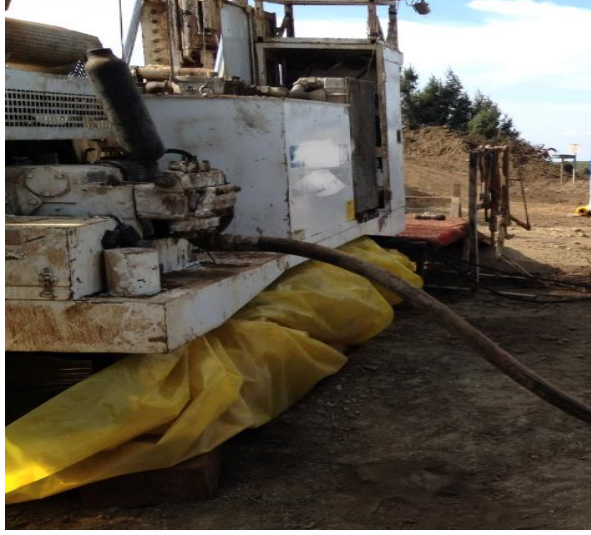
Resim 4.26. Gözlem yapılan sahalardan birinde yer alan sondaj makinesi taban desteđi
