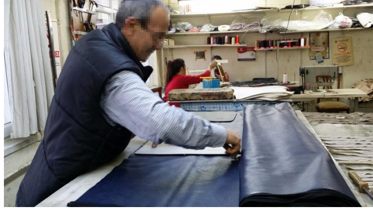
Resim 4. Deri toplarından deri parçalarının modele göre kesilmesi
