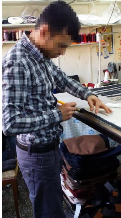
Resim 7. Parçalara yapıştırıcı sürülmesi
