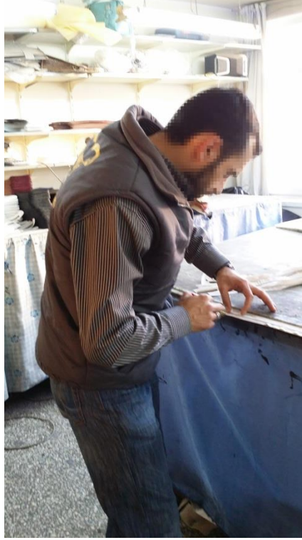
Resim 17. Parçalara yapıştırıcı sürülmesi görevi – çalışan 1
