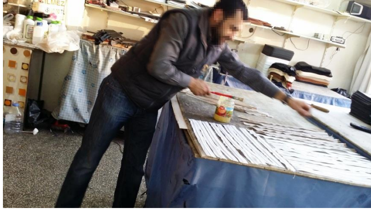
Resim 12. Parçalara yapıştırıcı sürülmesi ve yapıştırıcı sürülen parçanın tezgâha dizilmesi görevi
