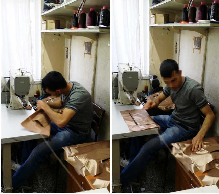
Resim 9. Parçaların dikiş ile birleştirilmesi
