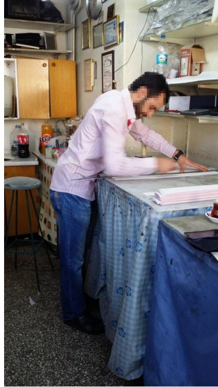
Resim 4. Deri toplarından deri parçalarının modele göre kesilmesi
