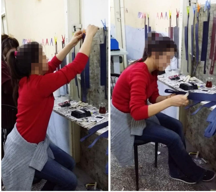
Resim 6. Kesilmiş deri parçalarının boyanması
