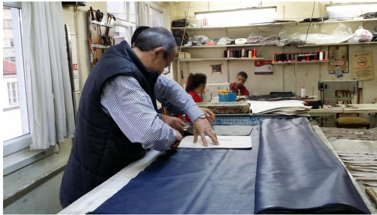
Resim 15. Derinin çıkarılan modele göre kesilmesi görevi
