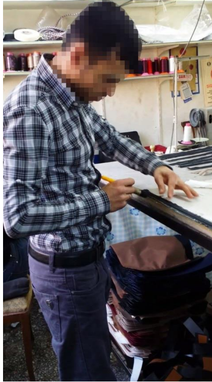
Resim 18. Parçalara yapıştırıcı sürülmesi görevi – çalışan 2
