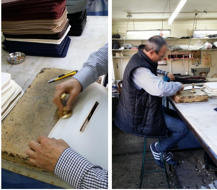
Resim 20. Parçaların muştayla kıvrılması görevi
