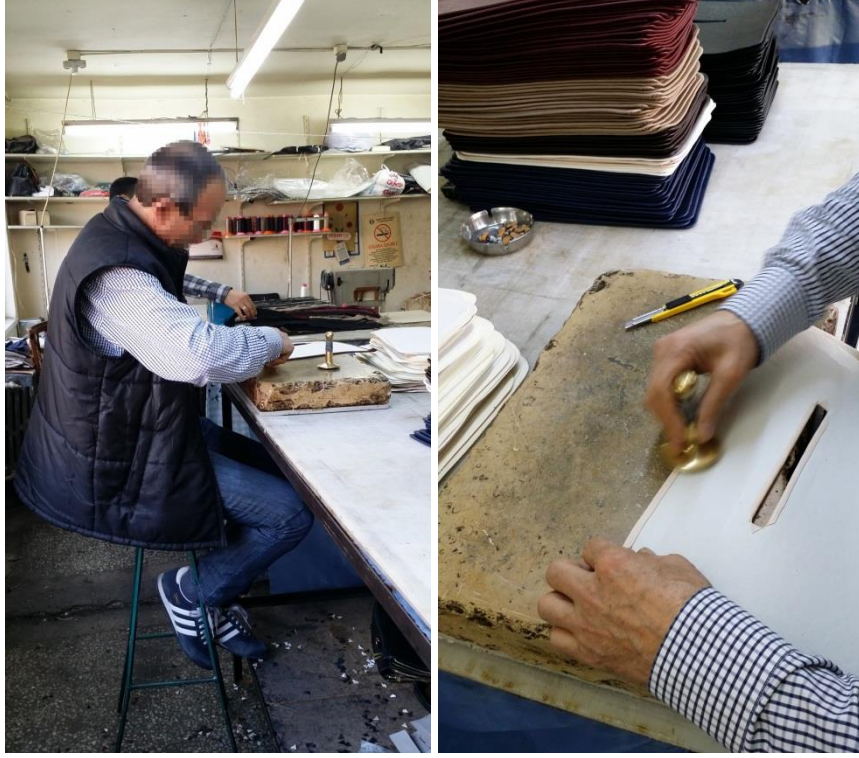
Resim 8. Parçaların muştayla kıvrılması
