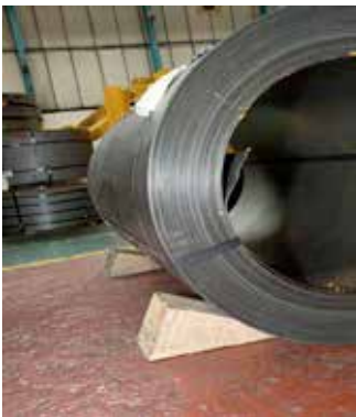
Şekil A.6.10: Silindirik malzemenin takozlarla sabitlenmesi
