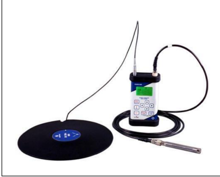
Resim 3.4. SVAN 947 Gürültü/Titreşim Ölçer ve SV 100 İvmeölçer
