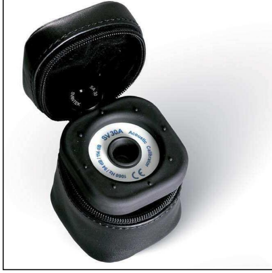
Resim 3.2. SV 30A Akustik Kalibratör
