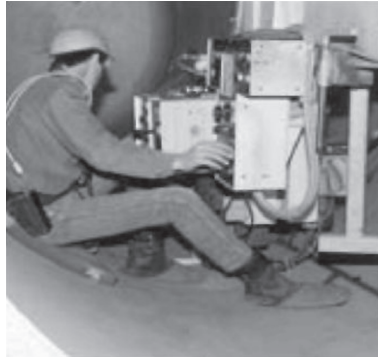
Şekil 9-3: Düşük tehlikeli madde emisyonlu toz altı ark kaynağı.
