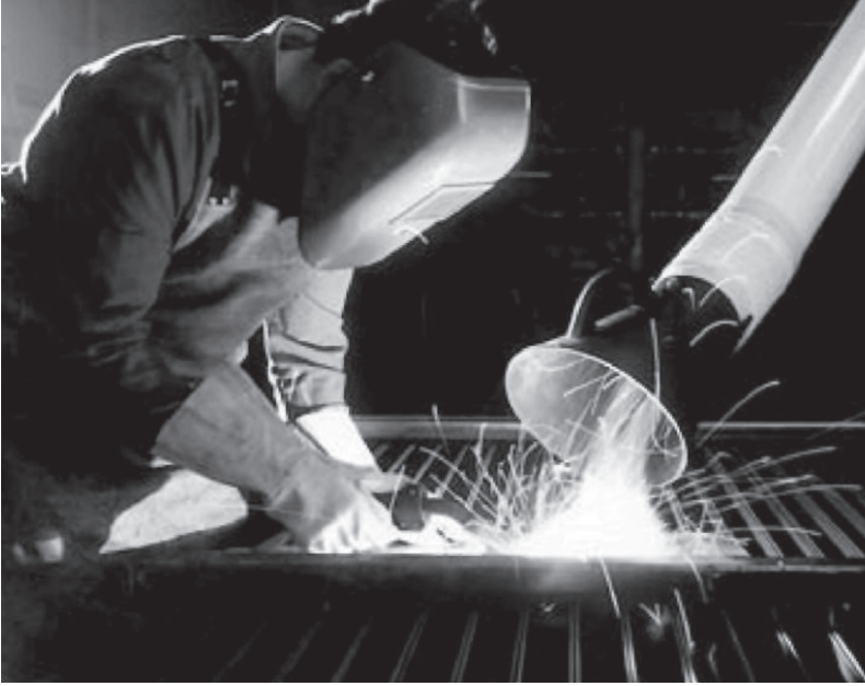
Şekil 9-7: Egzozlu gaz korumalı metal ark kaynağı(MIG/MAG)
