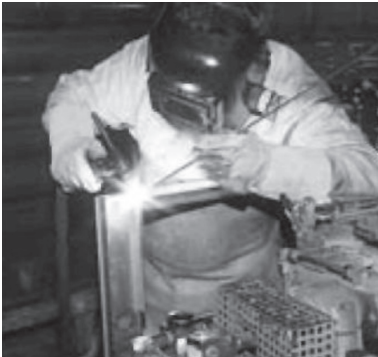
Şekil 9-2: TIG kaynağı, düşük kaynak dumanı emisyonlu bir işlem.
