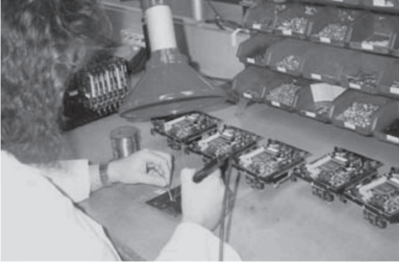
Şekil 3-4: egsoz sistemli lehimleme yapılan işyeri
