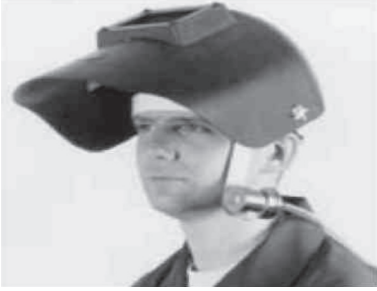
Şekil 5-5: Kaynakçının yüz kalkanına bir klips aracılığıyla iliştilirilmiş bir örnekleyici
