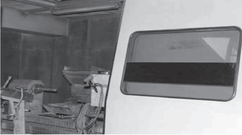
Şekil 9-5:Plazma ile spreyleme için kapalı kabin
