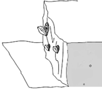
Şekil 2.8. Kazı Kenarından Parça Düşmesi [15]
