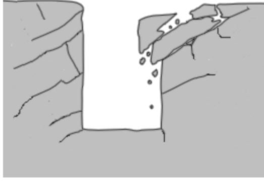
Şekil 2.10. Çatlaklı Kayaçlardan Oluşan Zemin [15]
