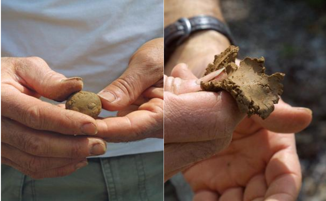
Şekil 4.25. Toprağın Ribbon Deneyi ile Manuel Analizi [45]
