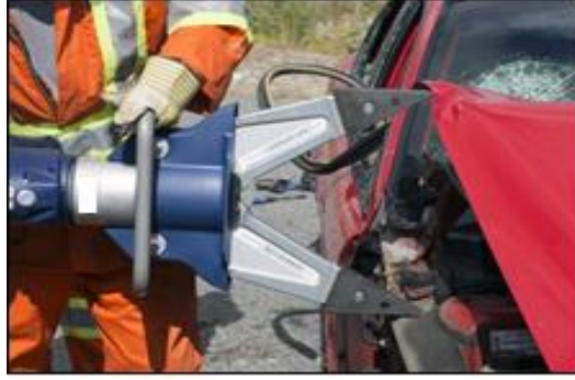
Resim 2.29. Hidrolik güç ünitesi, kesme takımları, delici ve kırıcılar
