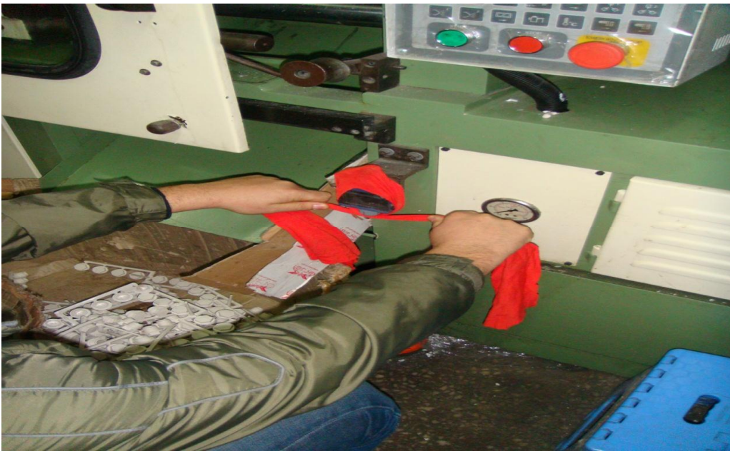
Resim 15. Plastik Enjeksiyon Kalıp Makinesinde Güvenlik Sensörünün Kapanması,
