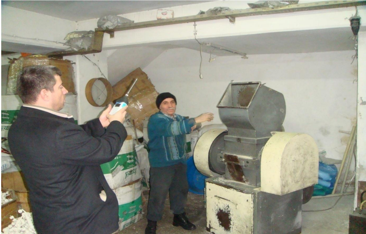
Resim 13. İnceleme Yapılan İşletmede Plastik Hurdaların Kırma Makinesinde Granül Hale Getirilirken Yapılan Gürültü Ölçümü
