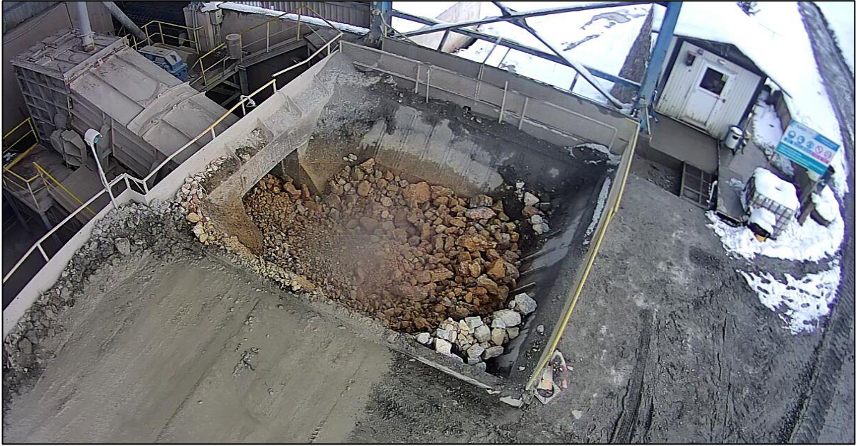
Resim 2.1. Hammaddenin Kırıcılarda Kırılması İşlemi
