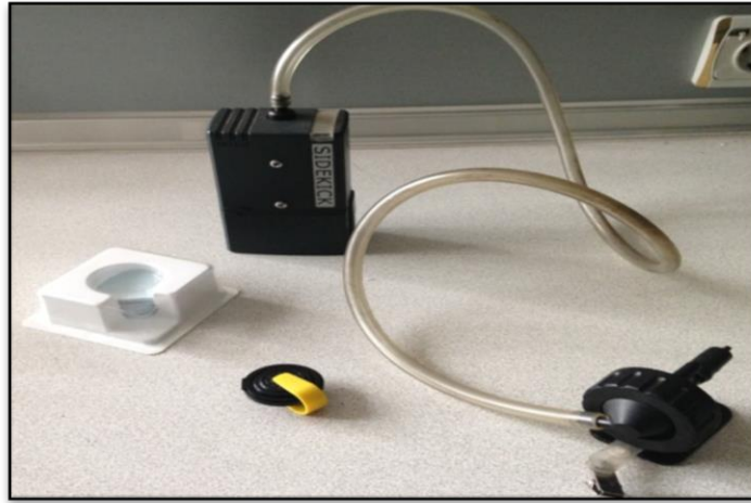
Resim 3.1. Kişisel Hava Örnekleme Pompası, Siklon Başlık, Filtre ve Filtre Kaseti
