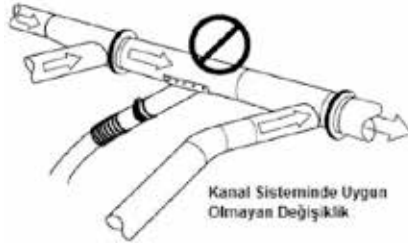
Şekil 5. Kanala yeni kol ekleme
