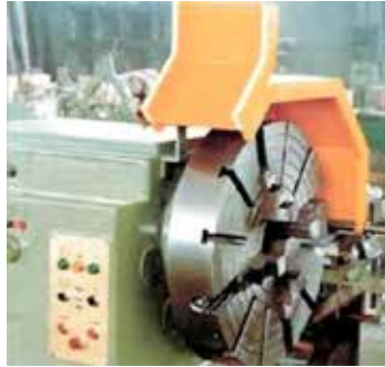
Resim.9 Dönen Mil için Koruyucu Örneği
