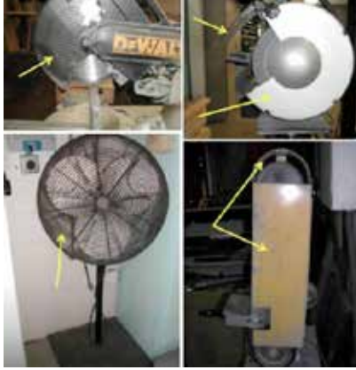
Resim.8 Dönen Parçalar için Koruyucu Örnekleri
