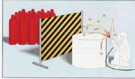
Resim 7. Sıçrayan kıvılcımlara sebep olan bir çalışmada perdeleme
