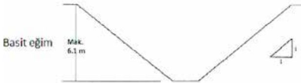
Şekil 26: B tipi topraklarda eğimli kazı
