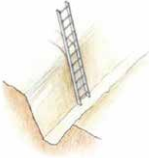
Şekil 36: Merdivenler kazının üzerine uzanmalıdır. 32
