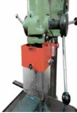
Resim.16 Radyal Matkap için Koruyucu
