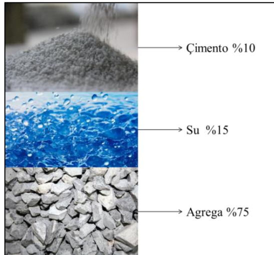
Şekil 2.1. Hazır beton bileşenleri
