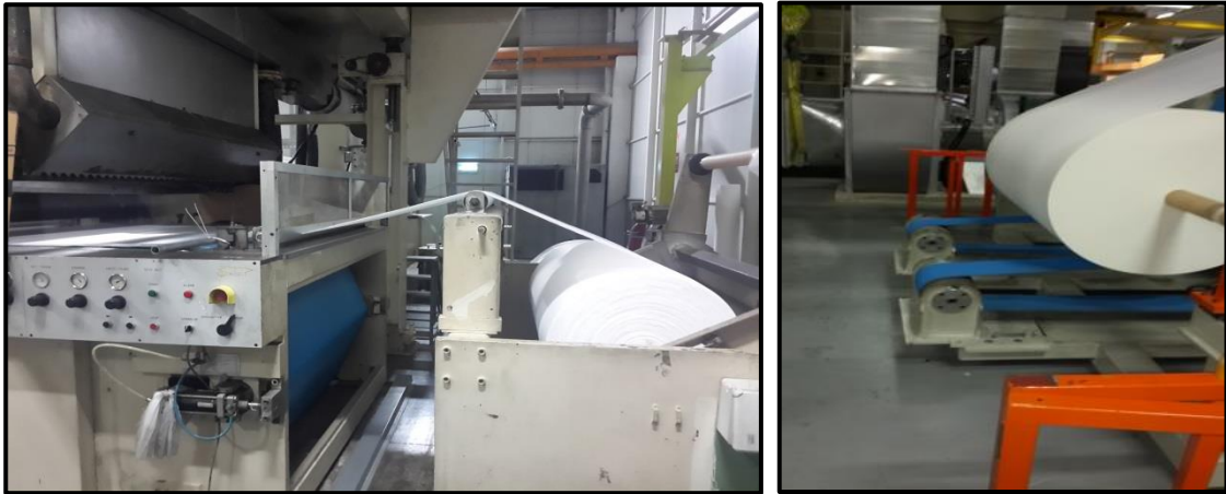
Resim 4.11. Kumaş sarma makinelerinde muhafazası bulunmayan sarım üniteleri
