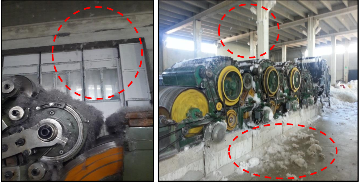
Resim 4.41. Silindir ve dişli sistemlerinin üzerinde muhafaza bulunmayan tarak makineleri ve üretimde ortaya çıkan toz ve uçuntular
