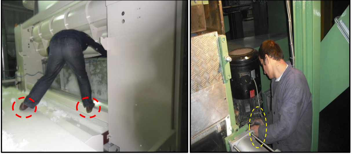
Resim 4.17. Bakım onarım işlerinde uygun kişisel koruyucu donanım kullanılmaması
