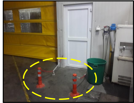
Resim 4.25. Forklift çarpma riskine karşı çalışanların korunmasına yönelik uygulamalar
