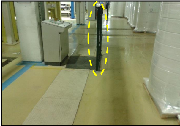
Resim 4.25. Forklift çarpma riskine karşı çalışanların korunmasına yönelik uygulamalar
