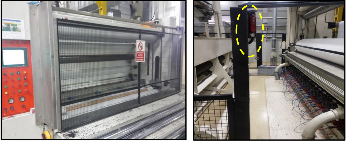
Resim 4.12. Kumaş sarma makinelerinde sarım ünitelerine uzuv kaptırma riskini önlemeye yönelik kafesli muhafaza ve makineyi durduran harekete duyarlı sensör sistemi uygulamaları
