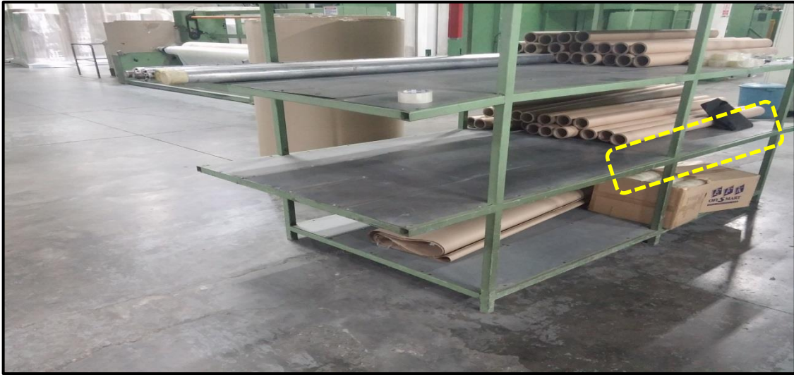
Resim 4.35. Silindirik yapıdaki malzemelerin istiflenmesinde raflarda yuvarlanarak düşmeyi önleyen etekliklerin bulunmaması
