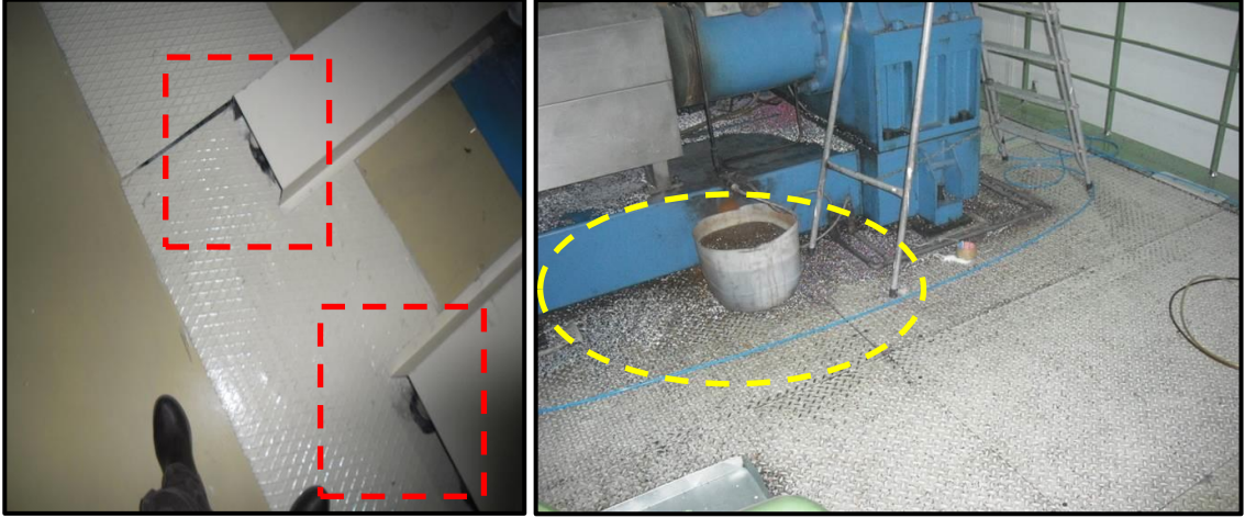
Resim 4.20. Zeminde seviye farklılıklarının uygun işaretlemeler ile belirgin hale getirilmemesi ve granül hammaddenin çalışma alanlarında zemine dökülmesi
