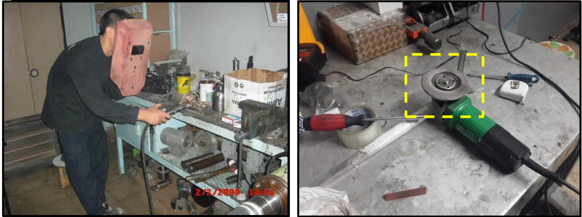
Resim 4.18. Bakım atölyelerinde kaynak işlerinde uygun kişisel koruyucu donanım kullanılmaması ve kesim işlerinde kullanılan muhafazasız ekipmanlar
