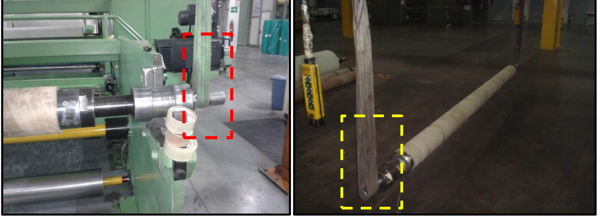
Resim 4.22. Vinç ile yük taşıma işlerinde yükün vinç kemerinden sıyrılarak düşme riski
