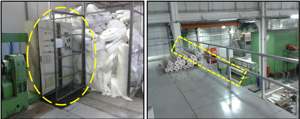
Resim 4.21. Çalışma alanlarında sonradan oluşturulmuş istifleme bölümlerinde tehlikeler
