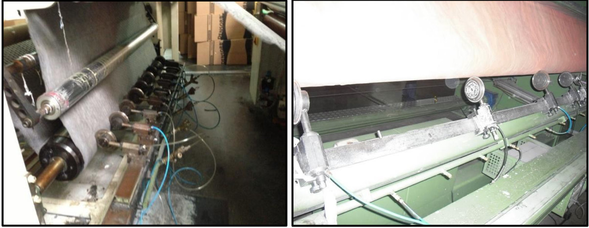
Resim 4.14. Kumaş kenar kesim ve dilimleme işlemlerinde kullanılan muhafazasız döner bıçaklar
