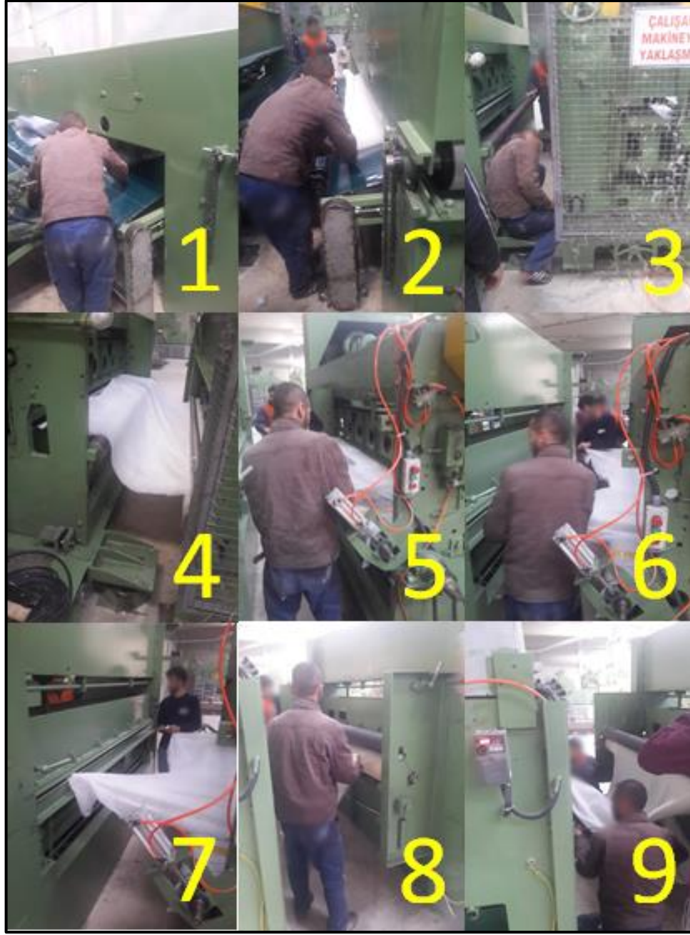
Resim 4.39. Kılavuz kumaş besleme (kumaşa yol verme) işlemi aşamaları
