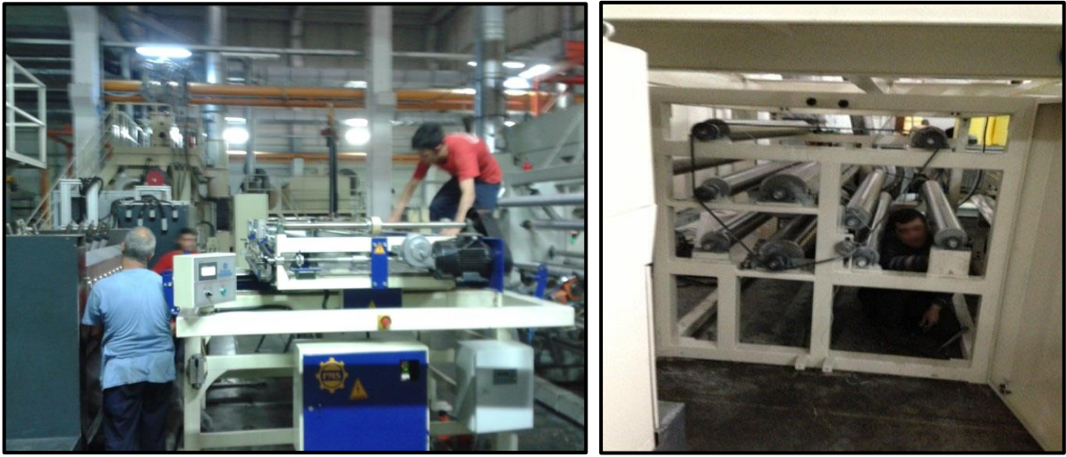
Resim 4.16. Makinenin durdurulmadan bakım onarım işlerinin yapılması durumunda tehlike teşkil edebilecek döner aksamlar
