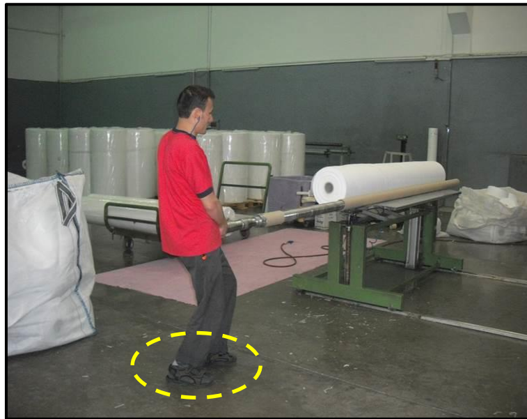
Resim 4.13. Makine milinin bobin içinden çıkarılması işlemini tek çalışanın yapması ve uygun koruyucu ayakkabı giyilmemesi tehlikeleri
