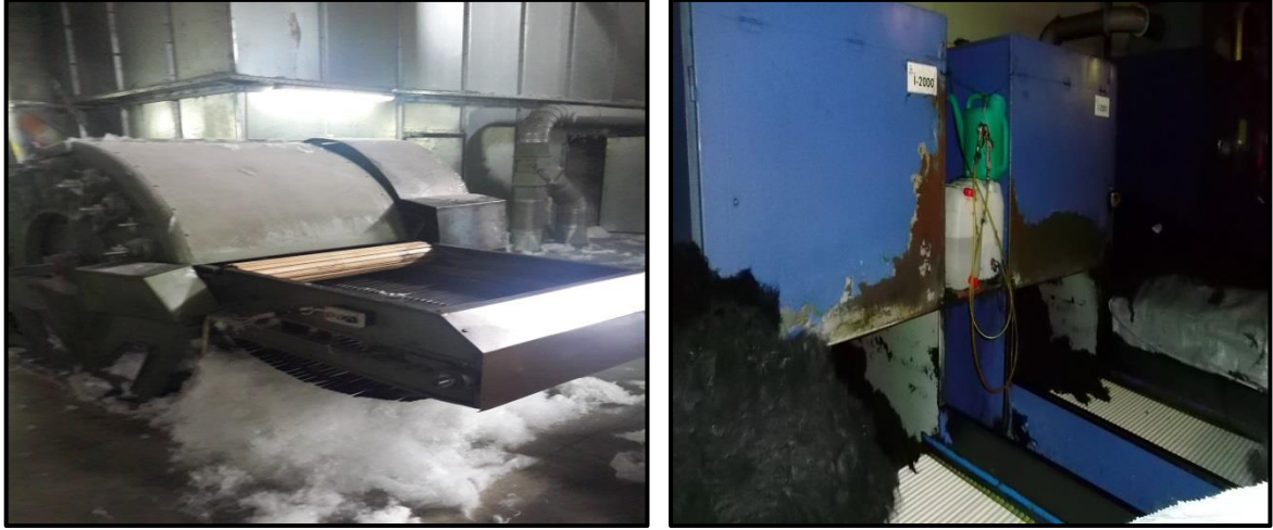
Resim 4.40. Harman hallaç makinelerinde ortaya çıkan uçuntular ve kimyasal kullanımı
