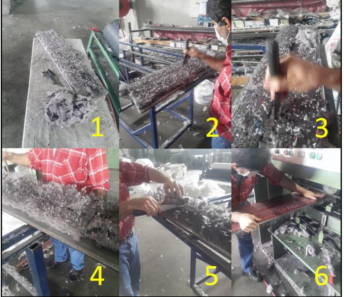
Resim 4.38. İğneli plaka temizleme işlemi aşamaları
