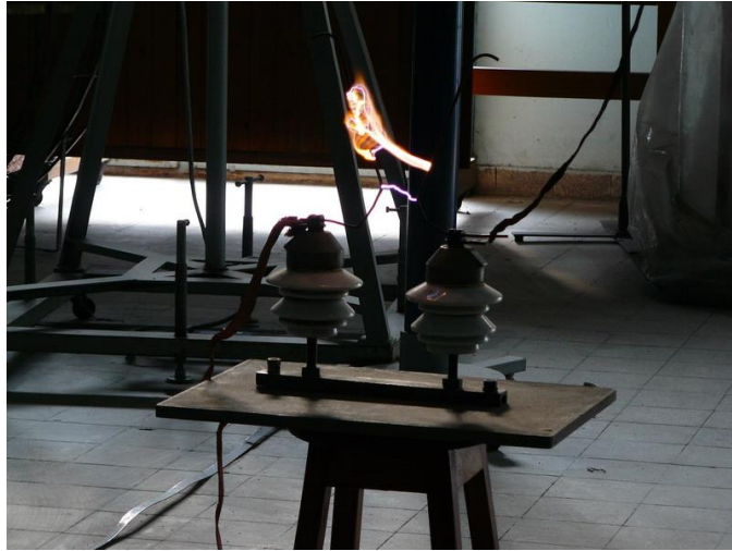
Şekil 18: Yüksek Gerilim Ark Boynuzu Deneyi (15)
