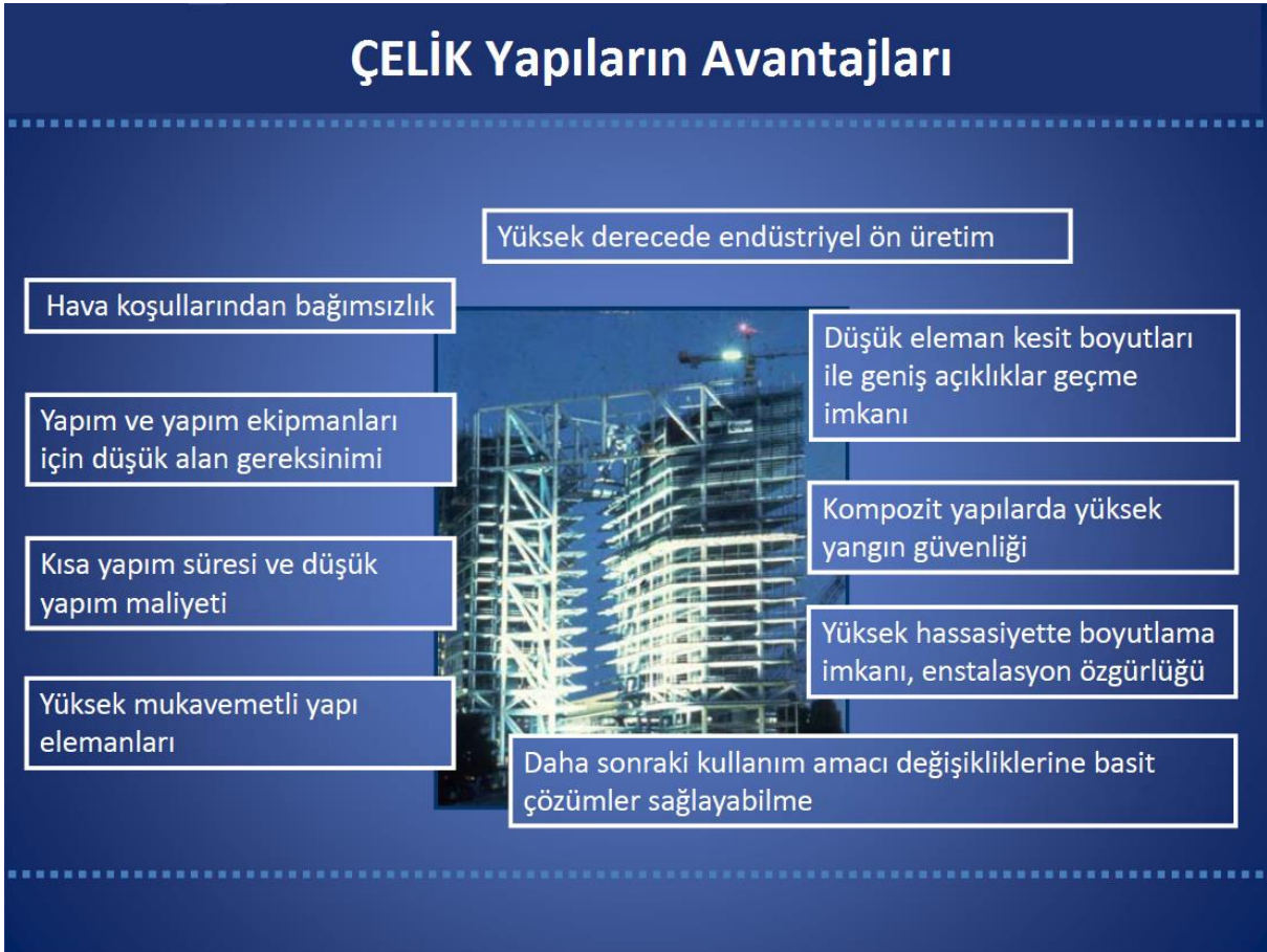
Şekil 2.1. Çelik konstrüksiyon yapı avantajları [13]
