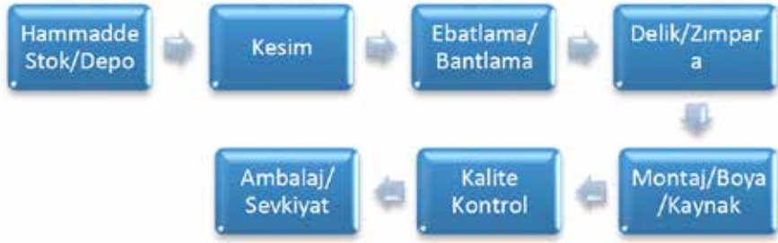
Şekil 2.1. Mobilya İmalatı Akış Şeması
