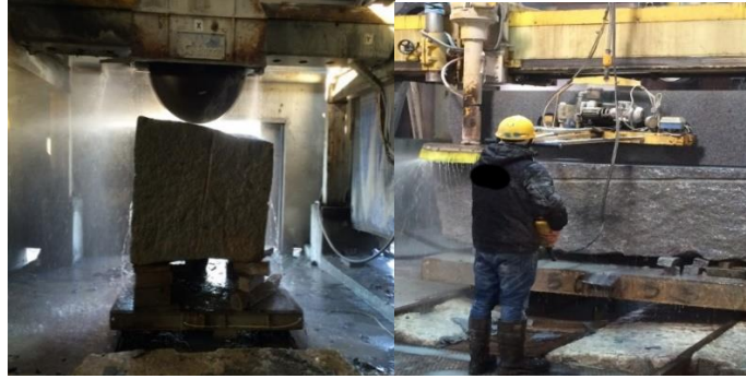
Resim 4.2. St makinası ve alt kesme prosesi
