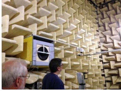
Resim 3.2. Sessiz oda ve kalibrasyon düzeneği örneği[34]
