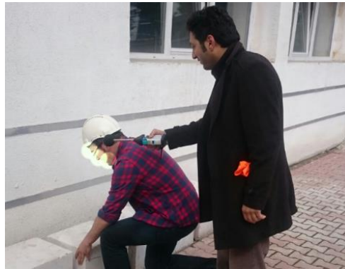
Resim 3.3. El tipi ses seviye ölçer kullanımı
