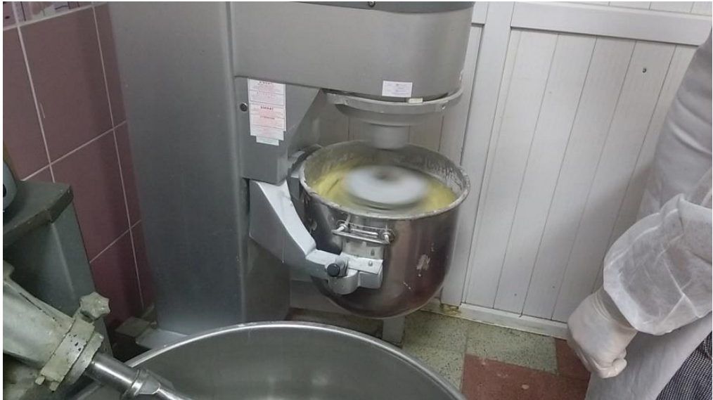
Resim 4.10. Koruması olmayan karıştırıcı
