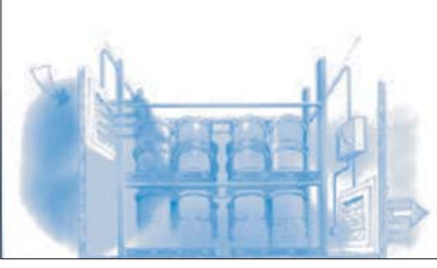
Resim 1. Havadaki ağır gazlar için havalandırma işleminin doğru düzenlenmesinin örneği
