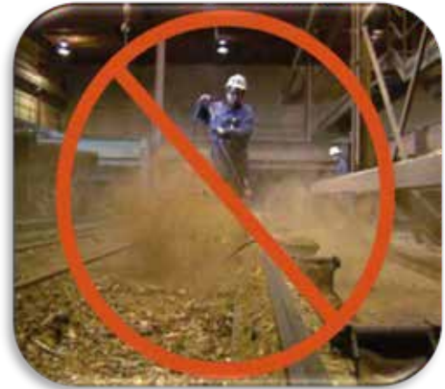
Şekil 3.4 Hava tabancasıyla toz temizlenmemelidir
