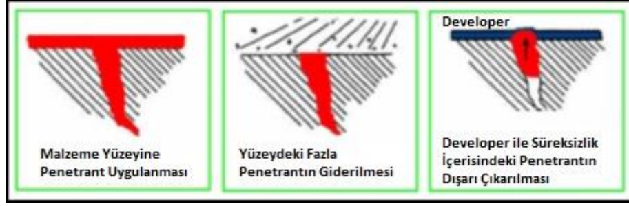
Şekil 2.2. Penetrant uygulanması [28]
