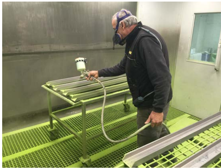
Resim 4.4. Sulu havalandırma sistemli boya kabini
