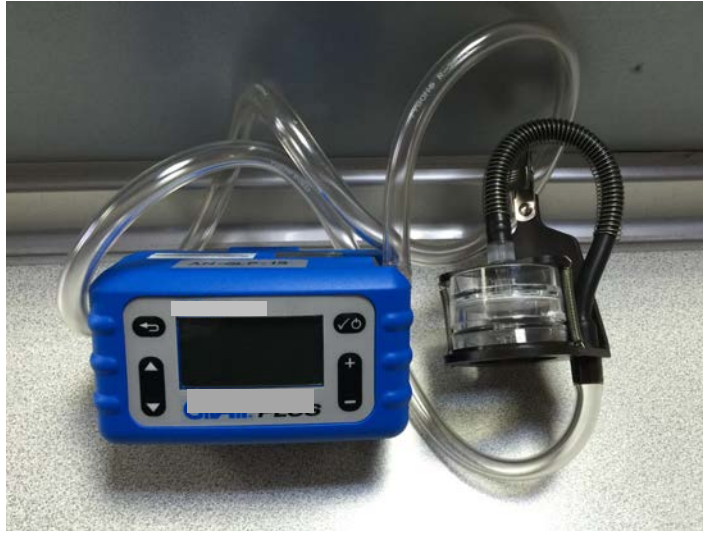
Resim 3.1. Ağır metal numune alma pompası ve filtre başlığı
